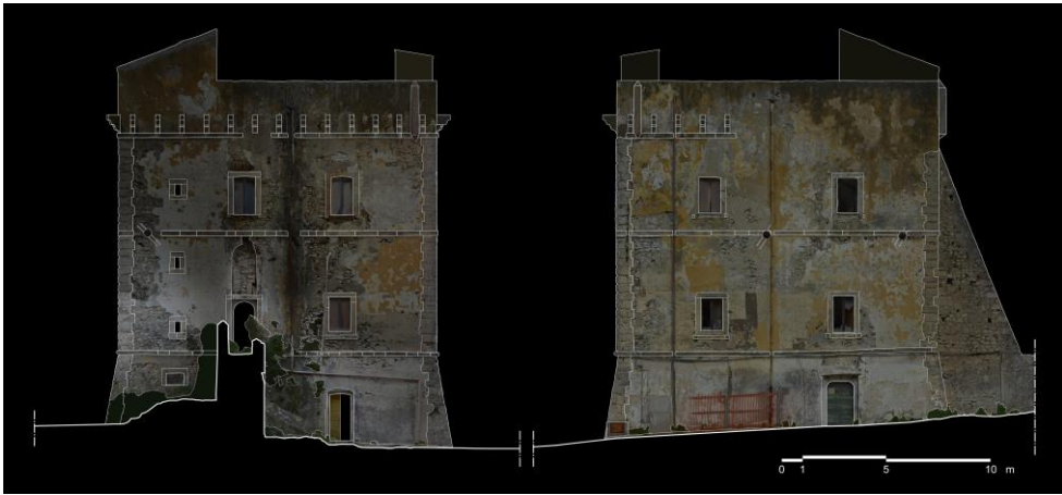
Fig. 8- Torre di San Menaio. Architectural survey of the elevations
