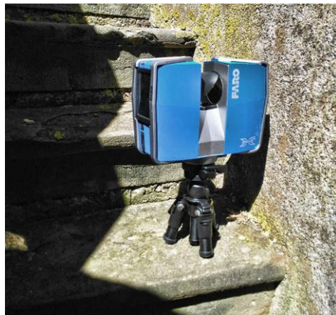
Fig. 5- Uso del mini treppiede per la ripresa di scale e piccoli vani (A. Peruzzi, 2017)
