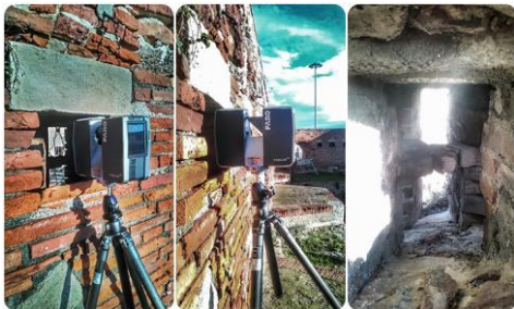
Fig. 4- Uso della testa a sfera per la ripresa all'interno delle fuciliere (G. Verdiani, 2017)
