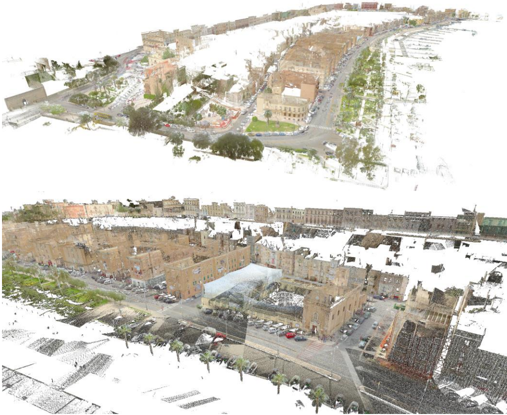
Fig.5-6 visualizzazione della nuvola di punti acquisita mediante laser mobile
